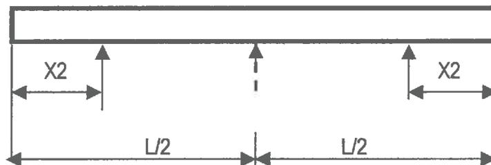
Für die Lagerung auf der Baustelle werden Lagerhölzer im Abstand  $X_2 = 0.20 \cdot L$  angeordnet.
